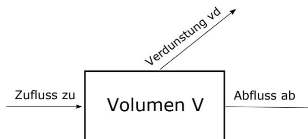
Abbildung 14.2: Schematische Darstellung des Modellsees. Die Pfeile stellen hier materielle Flüsse dar (Wassermengen pro Zeit).
